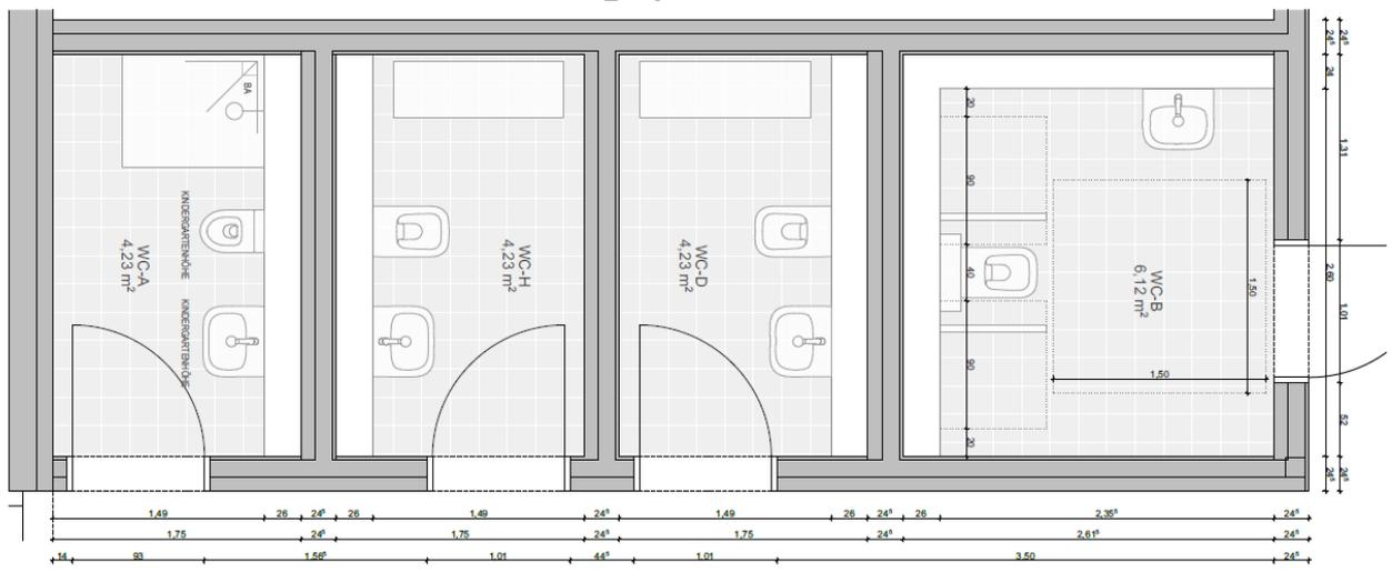
Die Sanitärspanne besteht aus vier angrenzenden WCs, welche mit einer Toilette und einem Waschbecken ausgestattet sind. Im Damen- und Herren-WC befindet sich zusätzlich ein kleiner Schrank. Darüber hinaus verfügt das Außen-WC über eine Dusche. Außerdem gibt es ein barrierefreies WC.
